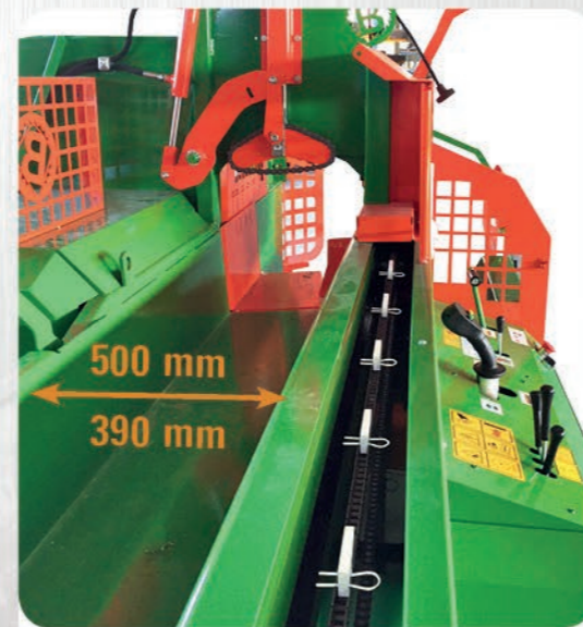
• AMPIA VASCA SPINTORE CON BLOCCAGGIO IDRAULICO SUPERIORE • OPTIONAL MISURAZIONE AUTOMATICA LUNGHEZZA PEZZI SU CATENA
