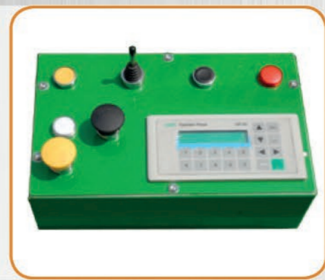
• OPTIONAL PLC PER AVANZAMENTO, BLOCCO, TAGLIO CON SISTEMA ANTI STRESS DISCO; DOTATO DI SCHERMO DIGITALE
